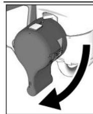
6. Placer le bouton de réglage de la pression sur la position AMORÇAGE/LENT, puis placer l'interrupteur MARCHÉ/ARRÊT sur la position **ON** pour démarrer le moteur. Le liquide de rinçage remonte dans le tuyau d'aspiration et sort via le tuyau de vidange au niveau du seau à déchets. Laisser le liquide de rinçage s'écouler du tuyau de vidange pendant 5 secondes.
