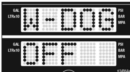
8. Appuyer brièvement sur la touche **DISPLAY** pour faire défiler les niveaux de sensibilité du système WatchDog. Maintenir la touche **DISPLAY** enfoncée pour régler le WatchDog sur les niveaux de sensibilité **LOW**, **MEDIUM** ou **HIGH**. Relâcher la touche **DISPLAY** lorsque la sensibilité souhaitée s'affiche à l'écran. Par défaut, la sensibilité est réglée sur le niveau **MEDIUM**.
