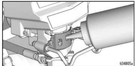
5. Veiller à ce que la buse de pulvérisation soit correctement insérée dans le support de buse de pulvérisation et que l'ensemble du support de buse de pulvérisation soit correctement serré sur le pistolet pulvérisateur. Consulter le manuel du pistolet pulvérisateur fourni séparément.
