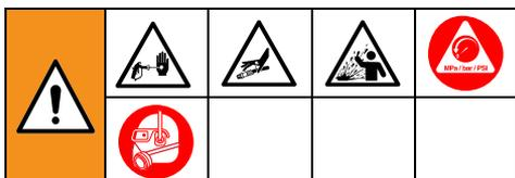
Cet équipement reste sous pression jusqu'au relâchement manuel de la pression. Pour éviter de sérieuses blessures provoquées par du produit sous pression, comme des injections sous-cutanées ou des projections de produit, appliquer la **Procédure de décompression** à chaque fois que le pulvérisateur est arrêté et avant le nettoyage ou la vérification du pulvérisateur, et avant que l'équipement ne fasse l'objet d'une réparation.
