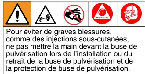
Afin de prévenir les fuites de la buse de pulvérisation, vérifier que la buse de pulvérisation et le garde-buse de pulvérisation sont correctement installés. Se reporter au manuel consacré au pistolet pulvérisateur pour plus d'informations sur le retrait et l'installation de la buse de pulvérisation, du joint et du garde-buse de pulvérisation.
