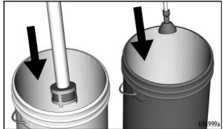
5. Tourner la vanne d'amorçage/rinçage vers le bas vers AMORÇAGE pour rincer le tuyau de vidange et la pompe.
