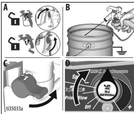
9. Poursuivre le rinçage du système jusqu'à ce que le liquide de rinçage soit clair.
