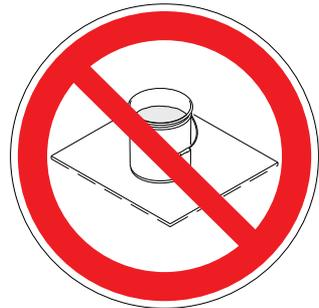
**Les seaux métalliques doivent être toujours mis à la terre** : raccordez un fil de terre au seau. Serrer une extrémité au seau et l'autre extrémité à une vraie prise de terre telle qu'un conduit d'eau.
