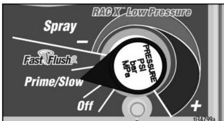
9. Dès que le liquide de rinçage sort du tuyau de vidange, placer le bouton de réglage de la pression sur la position **FastFlush** et patienter le temps du rinçage de l'appareil, soit 30-60 s.
