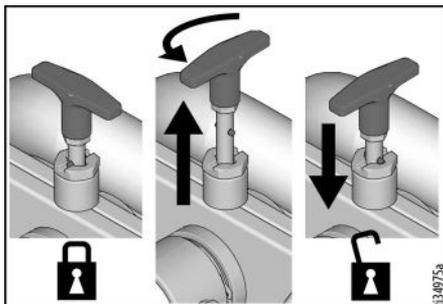
3. Pousser la poignée de l'enrouleur vers le bas et vers l'extérieur. Tourner dans le sens horaire pour enrouler le flexible.
