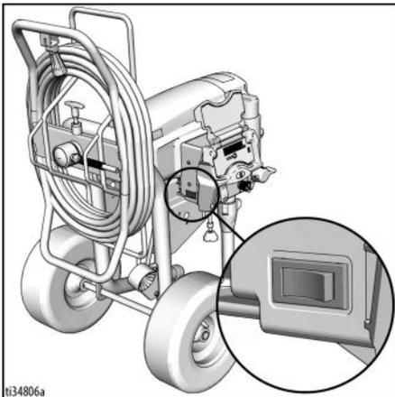
Si un circuit 16 A est disponible, utiliser le réglage 16 A afin d'optimiser les performances du pulvérisateur. Dans le cas contraire, utiliser le réglage 10 A.
