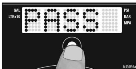
**NOTE :** En cas de défaut d'alignement, le message **FAIL** s'affiche à l'écran, puis le message **KNOB** s'affiche de nouveau. Vérifier que le bouton de réglage de la pression est correctement réglé, puis une nouvelle fois la procédure d'étalonnage.
