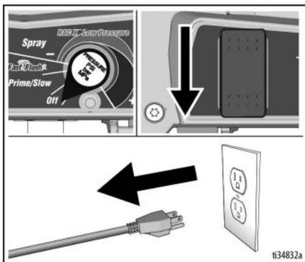
16. Mettre la vanne d'amorçage/de pulvérisation en position AMORÇAGE.
