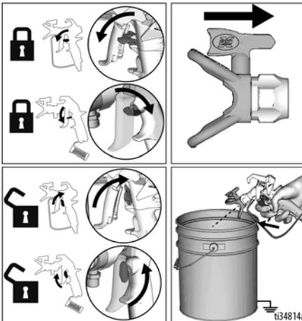
**NOTE** : Si la buse de pulvérisation est difficile à pivoter en tournant en position DÉBOUCHAGE, exécuter **Procédure de dépressurisation**, page 18, puis tourner la vanne d'amorçage/de pulvérisation à l'horizontale en position PULVÉRISATION et répéter l'étape 1.
