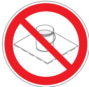
**Les seaux métalliques doivent être toujours mis à la terre :** raccordez un fil de terre au seau. Serrer une extrémité au seau et l'autre extrémité à une vraie prise de terre telle qu'un conduit d'eau.
