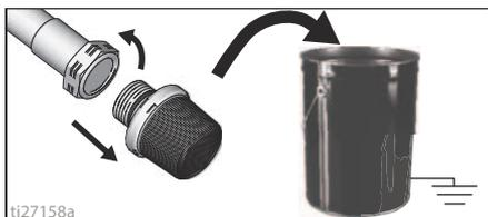
10. Branchez le tuyau d'arrosage sur le tuyau d'aspiration à l'aide du raccord de rinçage forcé. Laissez le tuyau de vidange dans un seau à déchets.
