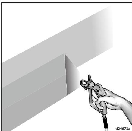
4. Actionner le pistolet après le mouvement. Relâcher la gâchette avant d'arrêter. Pour plus d'informations sur la pulvérisation, voir le manuel du pistolet.
