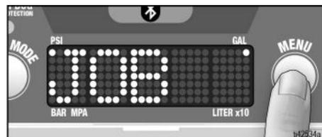
7. Appuyer et maintenir enfoncé le bouton de menu pour remettre à zéro ou appuyer brièvement sur le bouton pour passer à Lifetime gallons (ou litres x 10).
