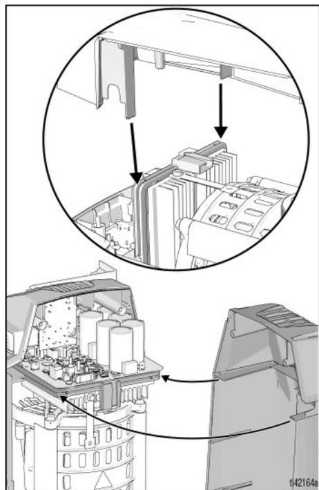
2. Pousser doucement vers le bas sur le dessus de la protection et, à l'aide d'un outil T20, serrer deux vis Torx T20 à 12-16 po.-lbs.
