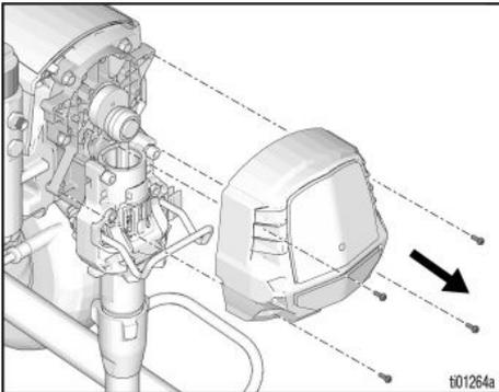
4. À l'aide d'une douille de 1/4 po, retirer les deux vis avant.
