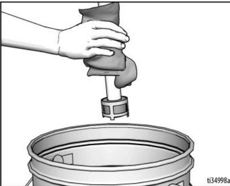
4. Plonger le tuyau d'aspiration dans le liquide de rinçage. Utiliser de l'eau pour rincer les peintures à l'eau et de l'essence minérale pour les peintures à l'huile. Placer le tuyau de vidange dans un seau à déchets.
