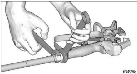
3. Utiliser deux clés pour le serrer fermement.
