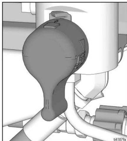
11. Placer le tuyau d'aspiration et le tuyau de vidange dans un seau métallique mis à la terre et partiellement rempli de liquide de rinçage. Voir **Mise à la terre**, page 16.
