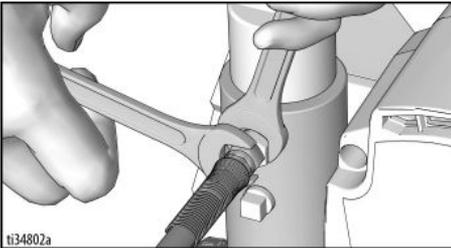
2. Brancher l'autre extrémité du flexible sur le pistolet.
