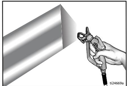
2. Utiliser une buse de plus petit diamètre si le réglage de la pression ne parvient pas à supprimer les bords trop chargés.
