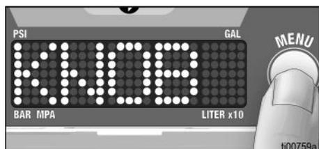
3. Régler le potentiomètre sur la position de pulvérisation maximale, juste avant TurboClean.
