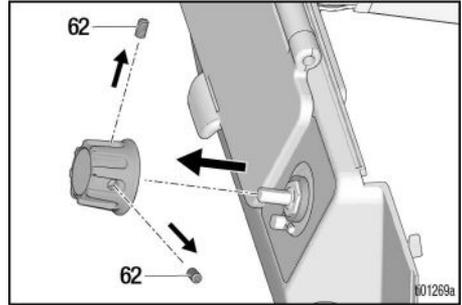
6. À l'aide d'une douille de 1/2 po, retirer le potentiomètre en dévissant l'écrou de retenue de l'écran.
