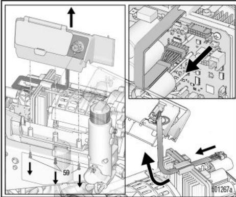
4. Débrancher le connecteur du câble du potentiomètre.
