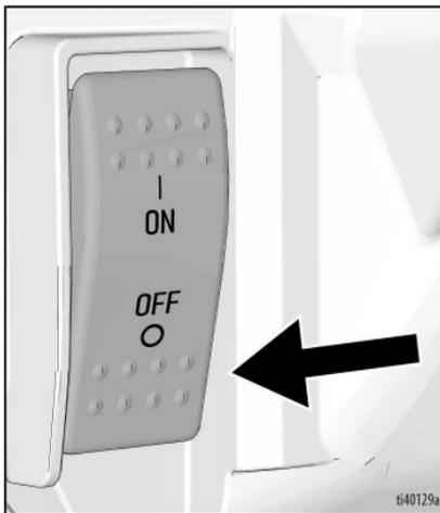
3. Mettre la régulation de pression sur la position **OFF** (ARRÊT).
