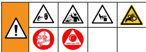
Pour éviter de graves blessures provoquées par du fluide sous pression, comme des injections cutanées, des éclaboussures et des pièces en mouvement, exécuter la **Procédure de décompression** une fois la pulvérisation terminée et avant un nettoyage, une vérification ou un entretien de l'équipement.
