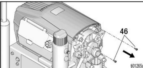
5. À l'aide d'un outil T20, retirer les deux vis Torx T20. Retirer la protection supérieure.
