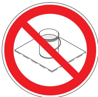
**Les seaux métalliques doivent toujours être mis à la terre :** raccorder un fil de mise à la terre au seau. Fixer une extrémité du fil au seau et l'autre extrémité à une vraie prise de terre telle qu'un conduit d'eau métallique.
