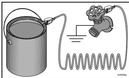
**Pour maintenir la continuité de mise à la terre lors du rinçage du pulvérisateur ou de la décompression :** maintenir fermement la partie métallique du pistolet pulvérisateur contre la paroi d'un seau métallique mis à la terre, puis actionner le pistolet.
