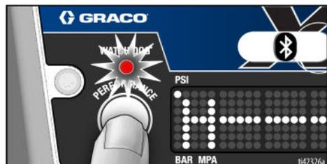
Il existe trois réglages de la sensibilité de la protection Watchdog : faible, moyen et élevé. Pour modifier le réglage de la sensibilité, saisir les données stockées sur l'écran et aller jusqu'à la protection Watchdog. Appuyer sur le bouton de menu et maintenir enfoncé pour activer la protection Watchdog.
