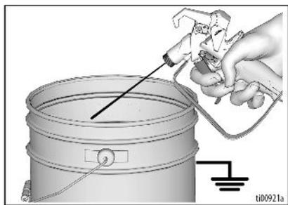
3. Enclencher le pistolet et tourner la régulation de pression sur TurboClean.
