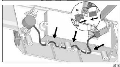
2. Tourner l'arbre du potentiomètre dans le sens des aiguilles d'une montre jusqu'à ce qu'il s'arrête, puis assembler le joint et le bouton avec l'indicateur pointé vers le bas (position TurboClean). Appliquer une force vers le bas sur le bouton et serrer les deux vis de réglage pour créer une légère traînée sur le joint. Serrer les vis du connecteur électrique au couple de 10-15 po.-lbs.
