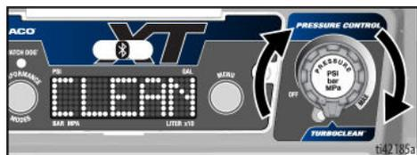
**REMARQUE :** TurboClean n'est utilisé que pour les liquides de nettoyage. En mode TurboClean, le pulvérisateur ne pulvérise pas de peinture ni d'autres produits.
