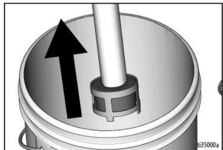
8. Tout en enclenchant le pistolet dans le seau de rinçage, tourner la régulation de pression sur TurboClean pour purger le liquide hors du flexible.
