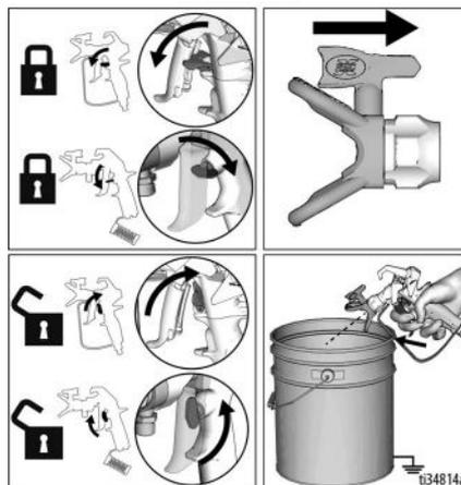
2. Verrouiller la gâchette. Remettre la buse de pulvérisation en position initiale. Déverrouiller la gâchette et continuer la pulvérisation.
