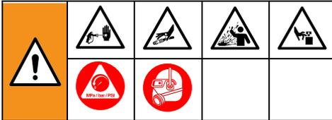
Cet équipement reste sous pression tant que la décompression n'a pas été faite manuellement. Pour éviter de graves blessures provoquées par du fluide sous pression, comme des injections cutanées, des éclaboussures et des pièces en mouvement, exécuter la **Procédure de décompression** une fois la pulvérisation terminée et avant un nettoyage, une vérification ou un entretien de l'équipement.
